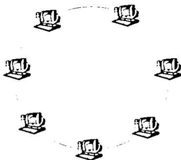
Trata-se de uma arquitetura ponto-a-ponto, sem terminadores, onde as estações são conectadas de forma circular. A topologia em anel resolveu um grande problema das tipologias em barramento, a colisão de pacotes. Apenas 1 máquina pode transmitir dados na rede. Para isso, o controle é feito através de um *token* (ficha), cuja estação que mantiver posse deste *token*, faz a transmissão. Topologias em anel,
