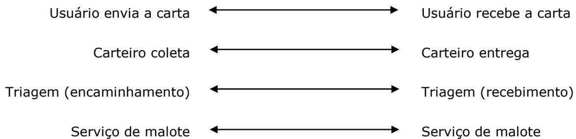
Cada camada do modelo OSI presta serviços à camada superior. Na transmissão de informações uma camada recebe dados repassados pela sua camada superior, faz um tratamento desses dados e repassa para a camada de baixo. As camadas da pilha de transmissão se comunicam apenas com as mesmas camadas de recepção da mensagem. Cada camada possui protocolos próprios, destinados aos serviços daquela etapa
