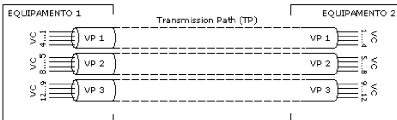
Redes ATM são orientadas à conexões, onde o pedido de conexão é feito através de sinalização onde uma célula é enviada pelo remetente, solicitando o procedimento. Caso seja aceito pelo destinatário, é estabelecido uma *Virtual Channel Connection* (VCC) e uma *Virtual Path Connection* (VPC). As conexões ATM são em sua maioria ponto-a-ponto, embora haja um pequeno uso entre computadores e servidores de alta performance.
