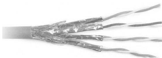
Os cabos STP (*Shielded Twisted Pair*) são uma adaptação do UTP para aumento de desempenho. Sua estrutura é idêntica, com fios de cobre trançados uns sobre os outros revestidos com plástico. A diferença está em camada metálica, chamada de malha, que envolve cada par, destinados a diminuir ruídos e interferências. Há ainda o SSTP (*Screened Shielded Twisted Pair*) ou SFTP (*Screened Foiled Twisted Pair*) que, além
