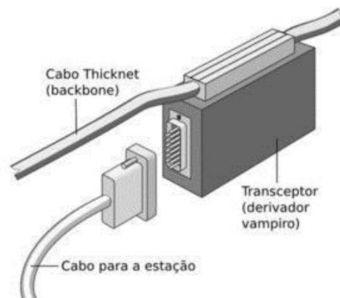
Para interligar as estações, era utilizado o cabo coaxial fino (chamado de *thinnet*, *thinwire* ou, na especificação técnica, RG-58), mais flexível e com distância máxima de 185m. Em uma das extremidades, o cabo conectava-se ao “vampiro” e na outra ligava-se à placa de rede da estação através de um conector do tipo BNC fêmea ou BNC tipo T.
