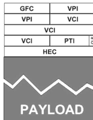
detectar e corrigir erros no cabeçalho. O *payload* representa a área útil para tráfego de dados. A informação é mantida intacta ao longo da rede, sem passar por correções ou verificações de erro.
